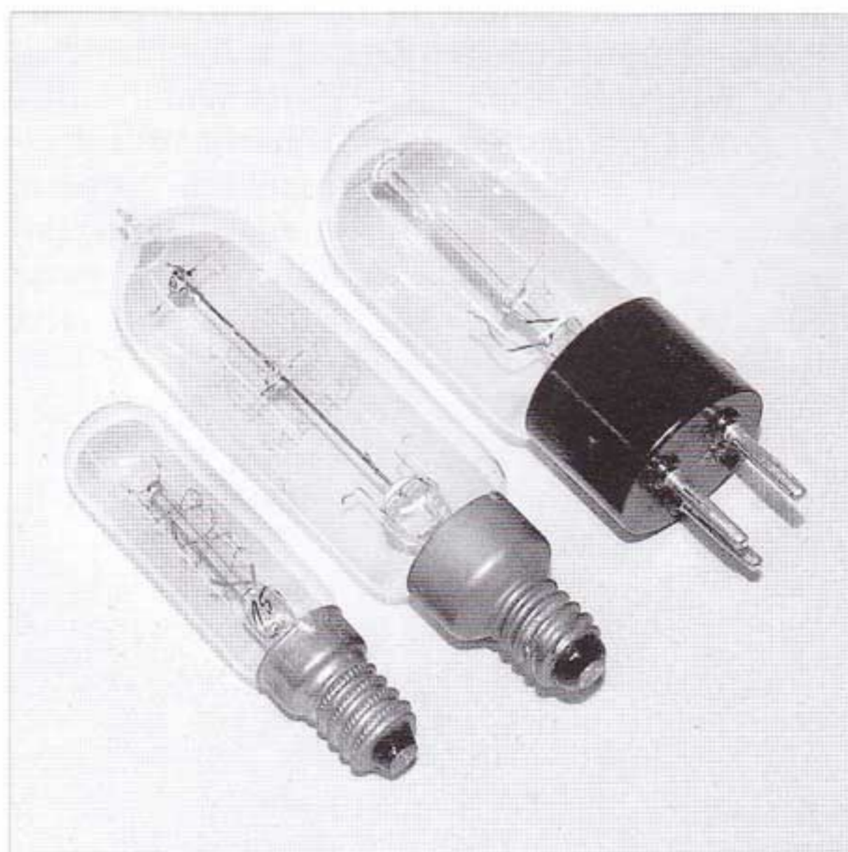
Bild 2: Ansicht vom Lorenz Original EW. 100 (Mitte), Äquivalent-EW Philips 1904 (rechts) und Ersatzlampe (links).
