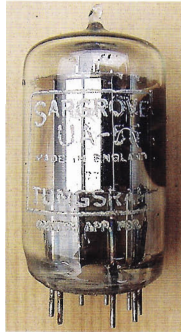
Bild 3 (oben). Die Elektrodenanordnung der Röhre UA-55 (Bild: © National Valve Museum)
