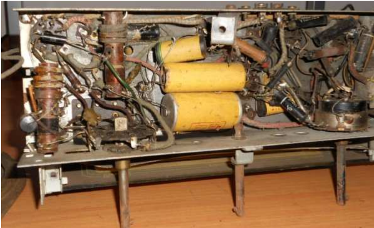
Fig. 4: parte inferiore dello chassis. Si notino i grandi condensatori elettrolitici CREAS, malamente saldati dalla parte della massa.
