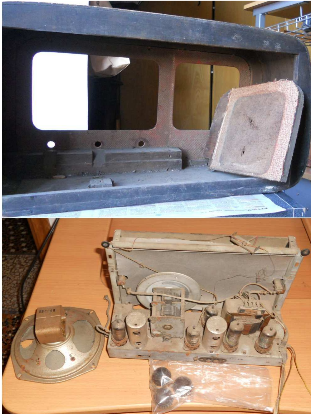
Fig. 2: il retro della radio ed il telaio estratto dal mobile. Si segnalano la funicella di sintonia strappata ed un foro sul cono dell'altoparlante. L'altoparlante è separato dal telaio ed i fili di collegamento sono dissaldati.
