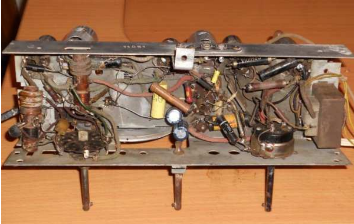
Fig. 5: la parte inferiore del telaio metallico dopo gli interventi di riparazione.
