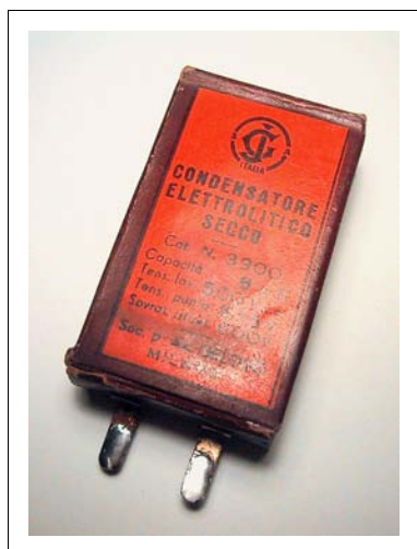
Il condensatore Geloso ricostruito
