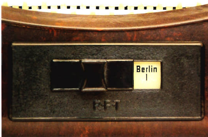
Bild 5: Beim links angeschlagenen Kolibri-Schiebeschalter war hier der DDR-Sender „Berlin I“ zu hören und nebenan „Berlin II“.
