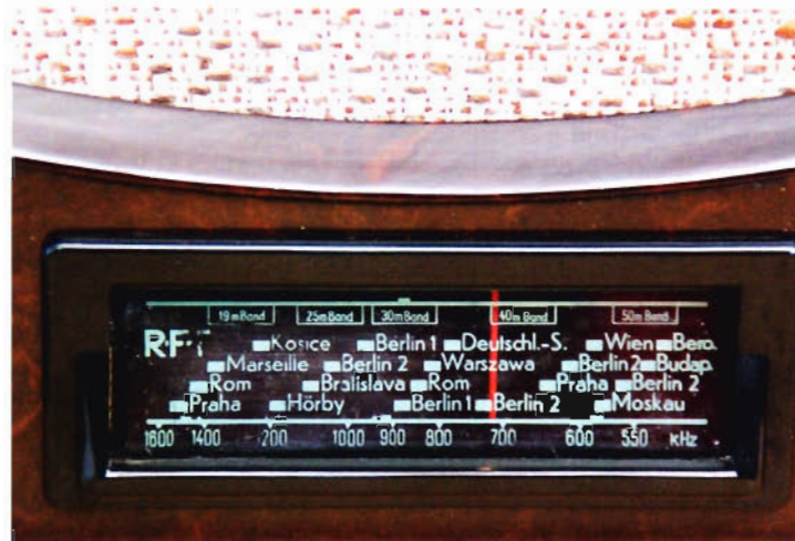
Bild 10: Flutlicht-Glasskala des „Zaunkönig“ mit MW-Frequenzbereich und Sendernamen sowie fünf KW-Bändern auf nur 94 mm x 27 mm Fläche.
