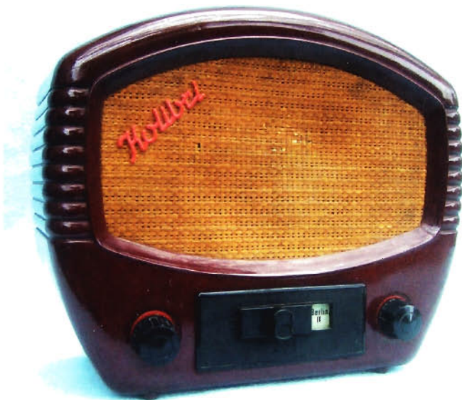
Bild 3: RFT-Einkreiser „Kolibri 2“ von 1954/55 mit Schiebeschalter zur Wahl zwischen zwei fest eingestellten Sendern auf Mittelwelle. Die Lautsprecherbespannung aus Flechtmaterial ist nach den vielen Jahren sehr empfindlich und oft beschädigt. Bild: Peter von Bechen
