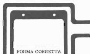
Fig. 7-B - Forma corretta degli angoli dei collegamenti stampati. Il raccordo in corrispondenza delle curve dà maggior sicurezza.
