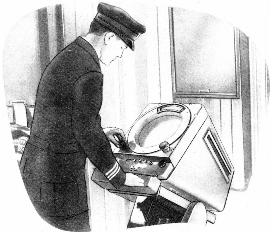
Fig. 3 - Apparecchiatura radar per marina
